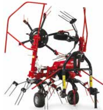
System zur Rotation der externen Kreiseln für eine kleinere Transportbreite.
