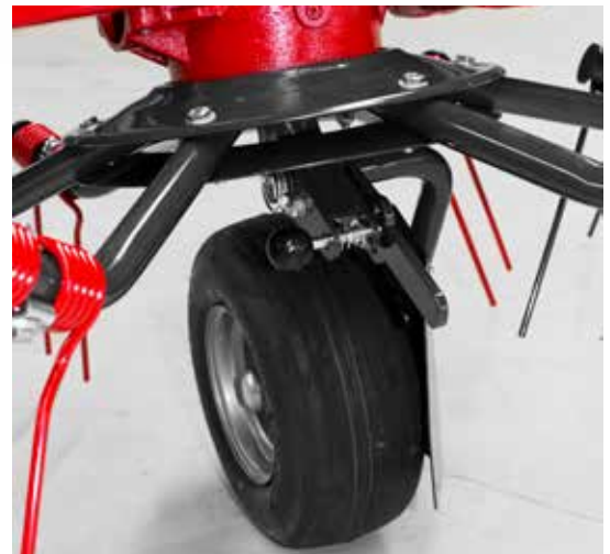
Räder mit mehrstufiger Höhen- und Streuwinkelseinstellung.
