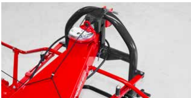
Schwenbock mit Dämpfstreben ermöglicht ein leichtes Folgen dem Traktor.
