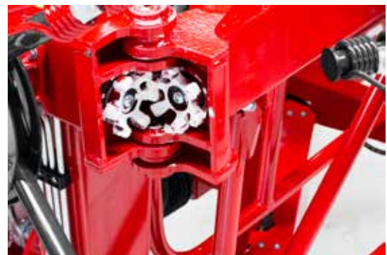
Klauenkupplung ist wartungsfrei und sorgt für eine zuverlässige Kraftübertragung in allen Arbeitsbedingungen.
