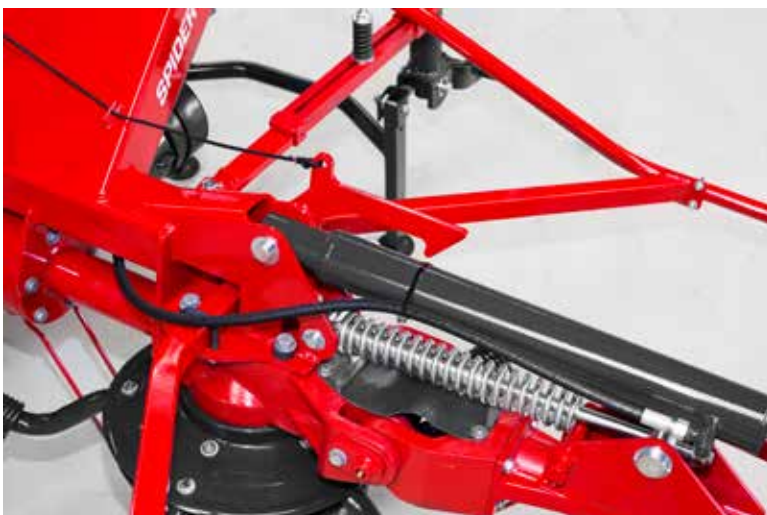
Hydraulische Faltung der Kreiseln können aus der Traktorkabine gesteuert werden.
