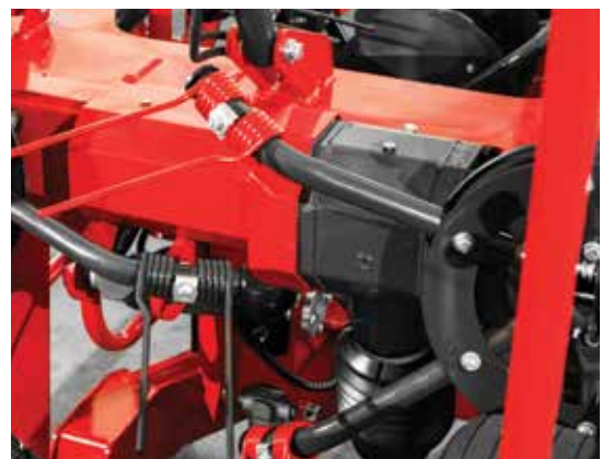
Sicherheitskupplung neben dem Hauptantrieb Getriebe an der Maschine montiert und gut für den Betrieb geschützt.
