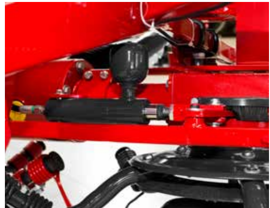
Hydraulikzylinder steuert alle Räder auf der rechten und linken Seite. Die Bedienung benötigen nur einen EW Steuerung. Der Gegendruck für die Bedienung führt durch den Hydrospeicher integriert in den Zylinder.
