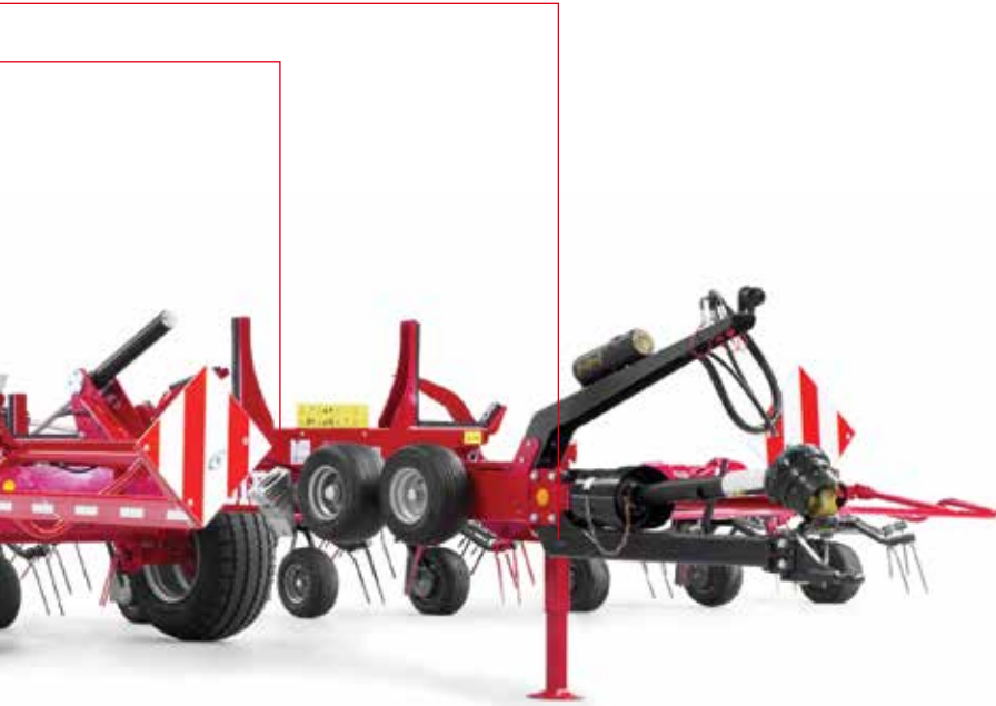
Verbundene Schutzvorrichtungen für zusätzliche Stabilität und Steifigkeit.
