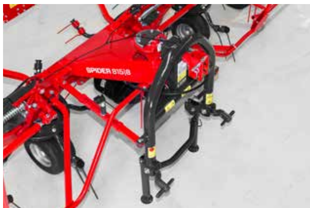
Schwenkbock, unterstützt durch Dämpfungsstreben, ermöglicht es, dem Traktor leichter zu folgen.
