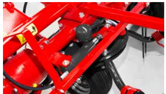
Alle mit HS gekennzeichneten Modelle sind serienmäßig mit einem zentralen hydraulischen Verschiebung ausgestattet.
