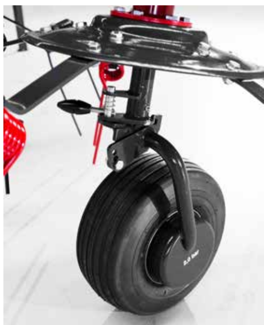
Räder mit Grenzstreueinrichtung und Höhenverstellung von rotor (SPIDER 400|4 ALP, 600|6 ALP)
