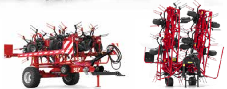
In geklappter Position ist die Maschine sehr kompakt und benötigt sehr wenig Platz.
