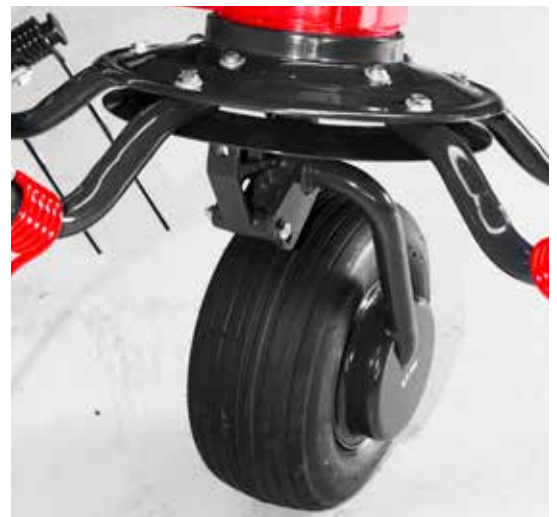
Räder mit MehrgangEinstellung der Höhe und schnelle Streuwinkelverstellung mit verschiebbaren Rädern.
