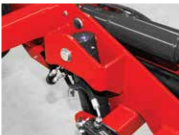
Kreiselneigungseinstellung (SIP-Patent) - Detail
