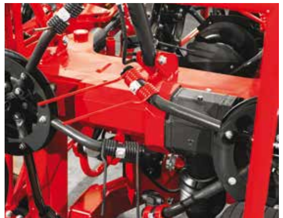
Ein innovatives System schützt getrennt die rechte und linke Seite des Zettwenders vor Überlastung.
