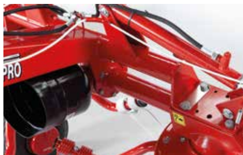
Direktantrieb ist über Gelenkwelle mit der Sicherheitskupplung bis zum Winkeltrieb und nach vorne über robuste Getriebe und Doppelkreuzgelenk mit Welle an den Kreisel verteilt.
