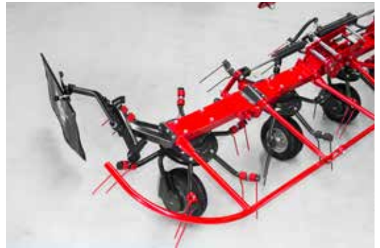
Verbundene Schutzvorrichtungen für zusätzliche Stabilität und Steifigkeit.
