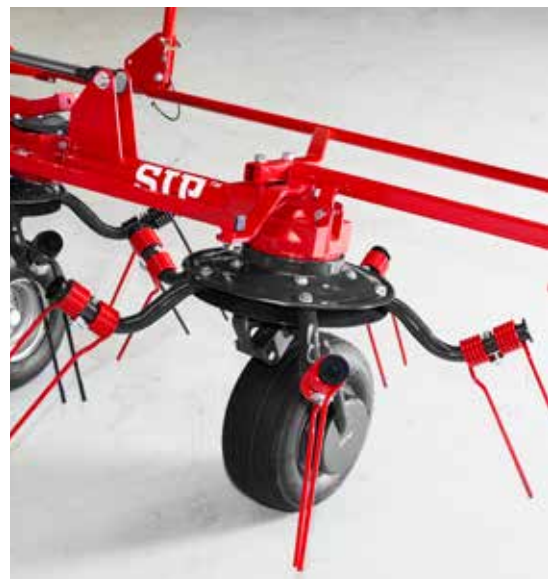
Kreisel und Federzinkenarme sind beim Wenden hoher Kraft ausgesetzt, weshalb sie aus robusten runden Rohren gefertigt werden. Den Federzinkenarmen bietet weitere Verstärkung der untere Ring an dem Kreisel.
