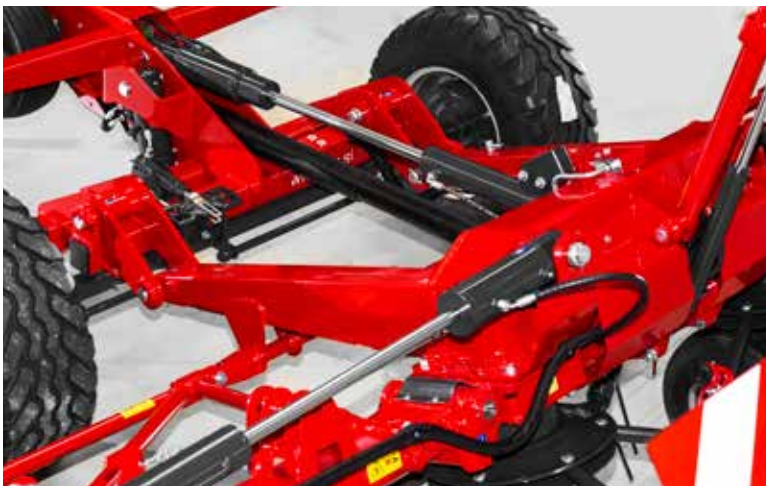
Kreiselneigungseinstellung (SIP-Patent) von 15° bis 21° (optional - hydraulisch) für gleichmäßiges Streubild.
