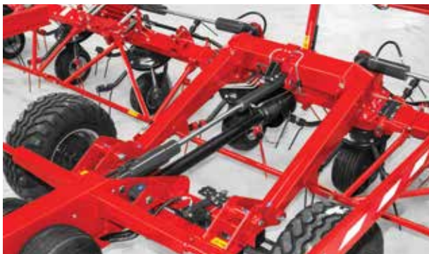
Durchdachtes hydraulisches Klappsystem ermöglicht eine schnelle Arbeitsvorbereitung, das Wenden und Transport selbst wie auch einfaches Rückwärtsfahren während der Arbeit.
