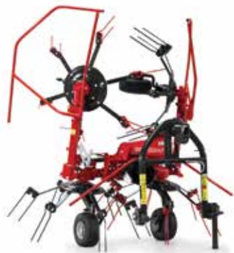
System zur Rotation der externen Kreisel für eine kleinere Transportbreite.
