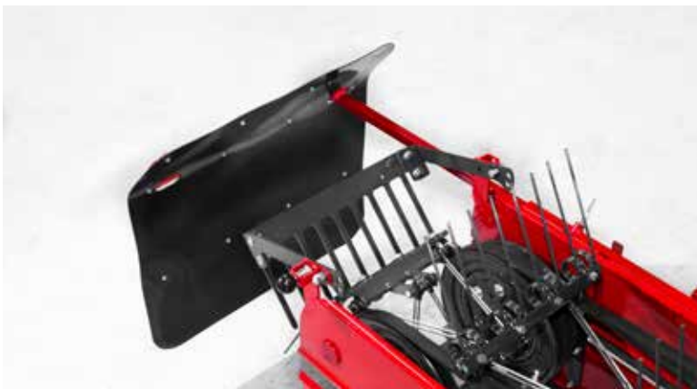
Das Schwadtuch bleibt jederzeit an der Maschine. Zwischen Schwad- und Wendeoption wählen wir durch Anheben des Schwastuchs (hydraulische Einstellung – Option). Gegenrechen (Option) verhindert die Ansammlung von Heu.
