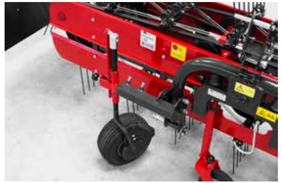
Doppelte Tasträder ermöglichen perfektes Folgen der Bodenkontur und eine höhere Arbeitsgeschwindigkeit.
