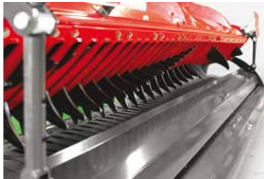
Der Fingerrotor in Kombination mit dem Pick-Up sorgt für einen perfekten Futterfluss.
