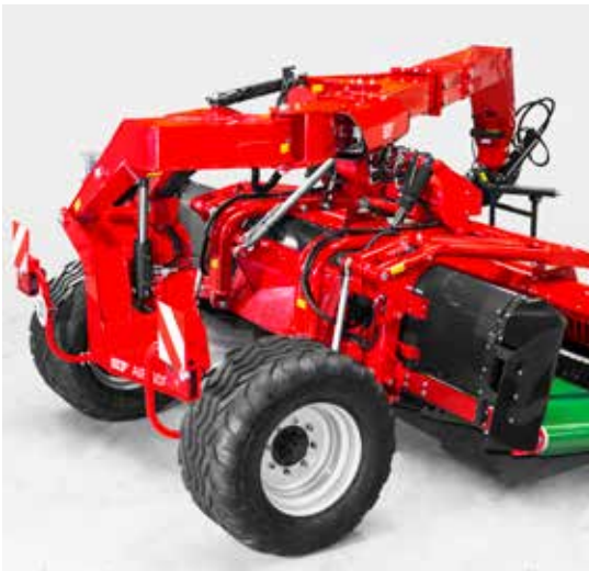
Durchdachtes Design des hinteren Transportrahmens mit Rädern in der Nähe der Pick-up-Einheit.
