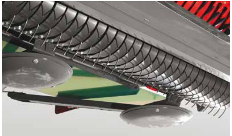
Die frei drehbaren Gleitkufen sind nahe am Pick-up positioniert. Die gezogenen Pick-up-Zinken berühren den Boden für weniger Verschleiß und eine längere Lebensdauer nur leicht.
