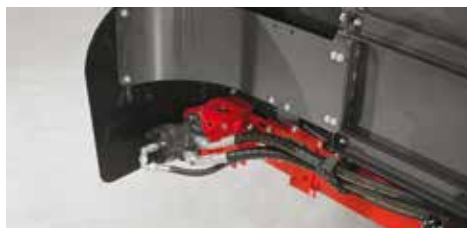
Die Richtung und Geschwindigkeit des Förderbandes wird einfach von einem Hydraulikmotor durchgeführt.
