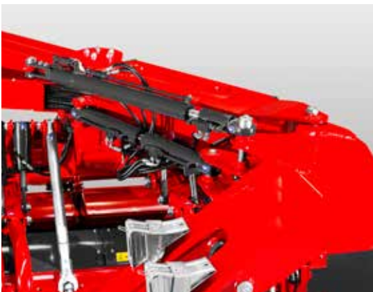
Das hydraulische Zylindersystem auf dem Transportrahmen ermöglicht der Maschine, von der Transportposition zu Arbeitsposition zu drehen – Entweder rechts oder links vom Traktor. Zusätzlich ermöglicht die 10°-Pick-up-Seitenverschiebung ein glattes Schwaden bei unkonditioniertem Futter.
