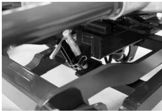
Leichte und einfache Höhenverstellung des Kreisels mit dem Gewindebolzen
