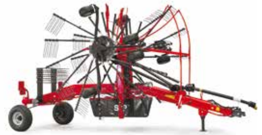
Transporthöhe in hochgeklappter Position beträgt weniger als 3,2 m.
