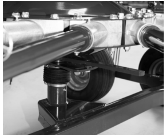
Einstellbare Kurvenbahn \pm 15^\circ - je nach Menge und Feuchtigkeit vom Futter.
