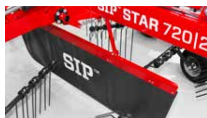
Einstellung der Schwadbreite beim STAR 650|20 T und STAR 720|22 T ist manuell.
