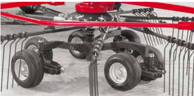
Ausgezeichnete Bodenadaptation aufgrund des aufgeteilten Schwerpunktes am Tandemfahrwerk (Bild rechts). Die Räder sind so positioniert, dass sie in der Nähe der Federzinken laufen (Bild oben) und gewähren daher maximale Rotorstabilität auch bei hohen Geschwindigkeiten.
