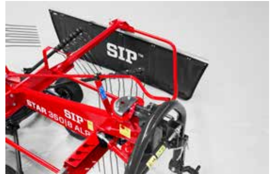
Die Höhenverstellung wird bequem über eine Kurbel gemacht.
