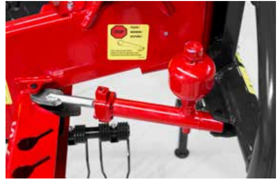
Zusätzliche Stoßdämpfer (optional für STAR 350|8 ALP) ermöglicht eine einfache Folgerung der Maschine.
