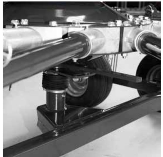
Einstellbare Kurvenbahn \pm 15^\circ - je nach Menge und Feuchtigkeit vom Futter.
