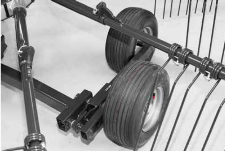
Schritt - Tandemachse für beste Bodenadaptation.
