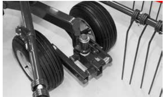
Flexible Schritt - Tandemachse auf dem Kreisell für eine ausgezeichnete Bodenadaptation und höhere Geschwindigkeit. Ein breites Fahrgestell mit 4 oder 6 Rädern, positioniert nahe an den Federzinken ermöglicht einen gleichmäßigen und sauberen Schwad über die gesamte Arbeitsbreite.
