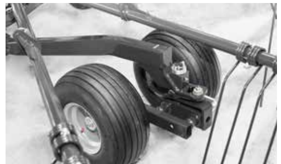
Flexible Schritt - Tandemachse auf dem Kreisler für eine ausgezeichnete Boden Anpassung und höhere Geschwindigkeit. Ein breites Fahrgestell mit 4 oder 6 Rädern, positioniert nahe an den Federzinken ermöglicht einen gleichmäßigen und sauberen Schwad über die gesamte Arbeitsbreite.
