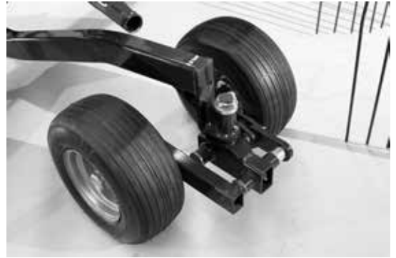
Flexible Schritt - Tandemachse auf dem Kreisler für eine ausgezeichnete Boden Anpassung und höhere Geschwindigkeit. Ein breites Fahrgestell mit 4 oder 6 Rädern, positioniert nahe an den Federzinken ermöglicht einen gleichmäßigen und sauberen Schwad über die gesamte Arbeitsbreite.
