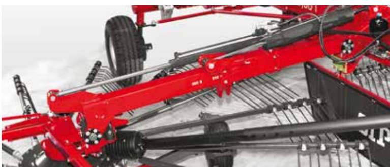
Stufenlose hydraulische Einstellung der Schwadbreite auch während der Arbeit
