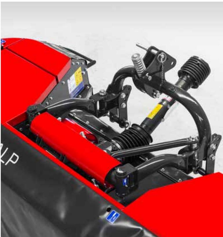
Die offene Konstruktion der Dreipunktgestänge für einfachen Zugang und Wartung aller Elemente.
