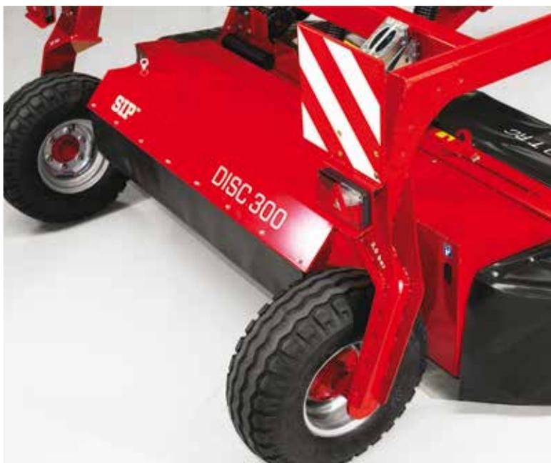
Räder für bessere Anpassung an den Boden, positioniert in der Nähe des Mähbalkens.
