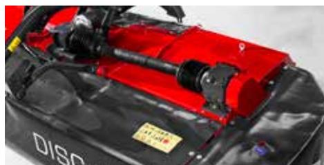
Direktantrieb auf die erste Mähscheibe über Gelenkwelle, Winkelgetriebe und Doppelkreuzgelenk
