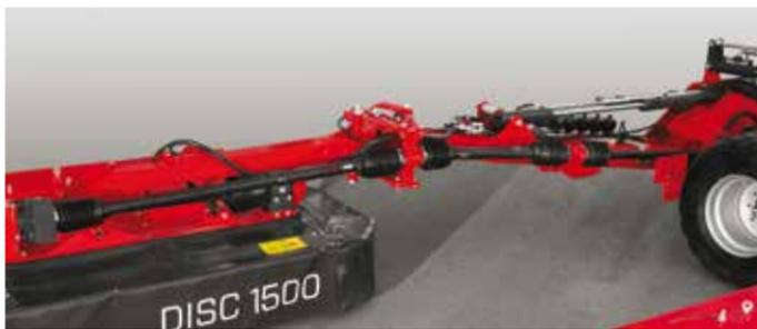
Direktantrieb auf die erste Mähscheibe über Gelenkwelle, Winkelgetriebe und Doppelkreuzgelenk.
