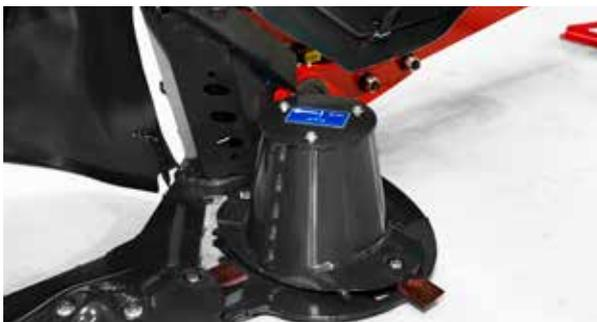
Direktantrieb durch das Getriebe hinter der ersten Scheibe.
