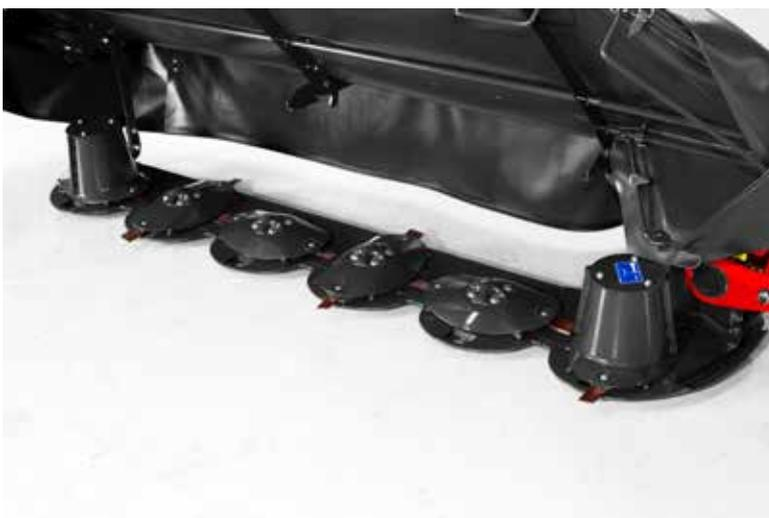
Kufen aus verschleißfestem Stahl (HARDOX) gewährleisten eine lange Lebensdauer sowohl bei Mähbalken als auch bei Scheiben. Die geschwungene Form der Kufen bietet eine große Auflagefläche und eine hervorragende Gleitfähigkeit durch die Oberfläche.
