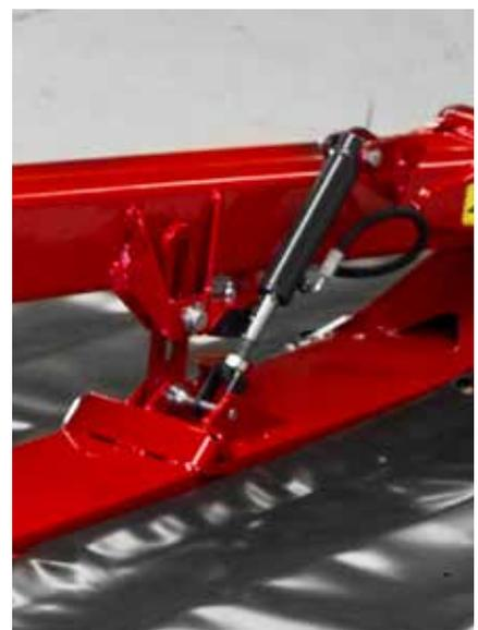
Hydraulisch gestützte Stabilisierung der Mähbalken ermöglicht sequentielle Aufhebung der Mähbalken. Zuerst hebt sich die Innenseite der Mähbalken und danach die Außenseite.
