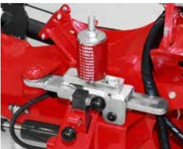
Bei einem Aufprall auf ein Hindernis schwenkt die Anfahrtsicherung das Mähwerk augenblicklich nach hinten und nach oben weg. Nach dem Auslösen der Anfahrtsicherung schwenkt das Mähwerk automatisch wieder in die Arbeitsstellung zurück.
