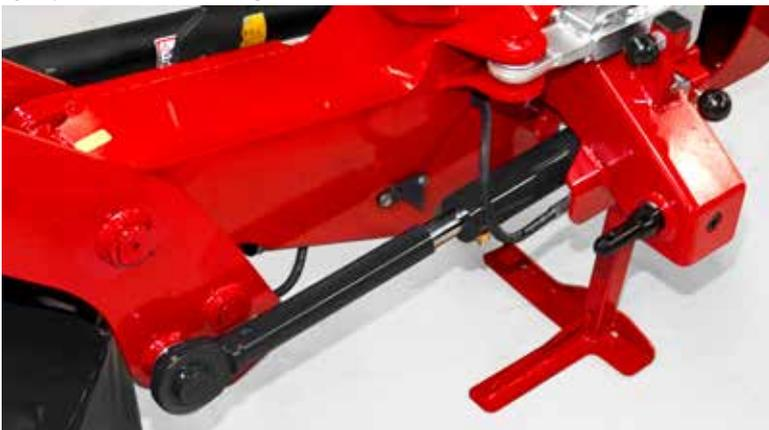
Zusätzliche Stützbein (Option) ermöglicht eine einfache Lagerung der Maschine.
