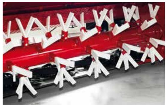
Der Zinkenaufbereiter (FC) ist mit Kunststoff-Zinken ausgestattet, die die Stiele nur öffnen, ohne zu mulchen. Der Aufbereiter bildet einen luftigen Schwad und beschleunigt die Feuchtigkeitsabgabe.
