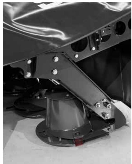
Der Schwerpunkt des Mähwerks liegt so nah wie möglich am Traktor. Der Mähbalken ist auf beiden Seiten mit Sohle verstärkt, was die Schadensgefahr an den Lagern am Mähbalken reduziert.
