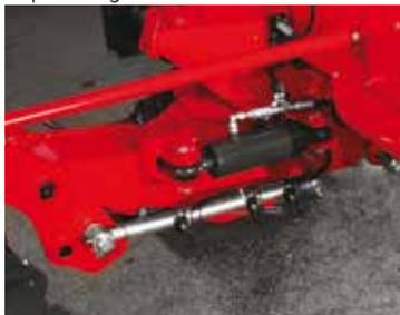
Bei einem Aufprall auf ein Hindernis schwenkt die Anfahrtsicherung das Mähwerk augenblicklich nach hinten und nach oben weg. Nach dem Auslösen der Anfahrtsicherung schwenkt das Mähwerk automatisch wieder in die Arbeitsstellung zurück.
