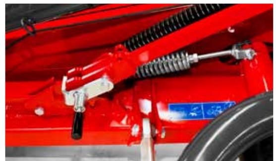
Federspann des Riementriebes
