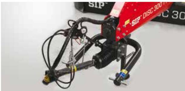
Das Eingangsgetriebe auf dem Gestänge kann um 90° gedreht werden
