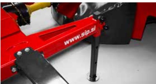
Einstellbare Stützbeine ermöglichen Lagerung der Maschine in Transportstellung auf einer Fläche von nur 3,2m<sup>2</sup>.
