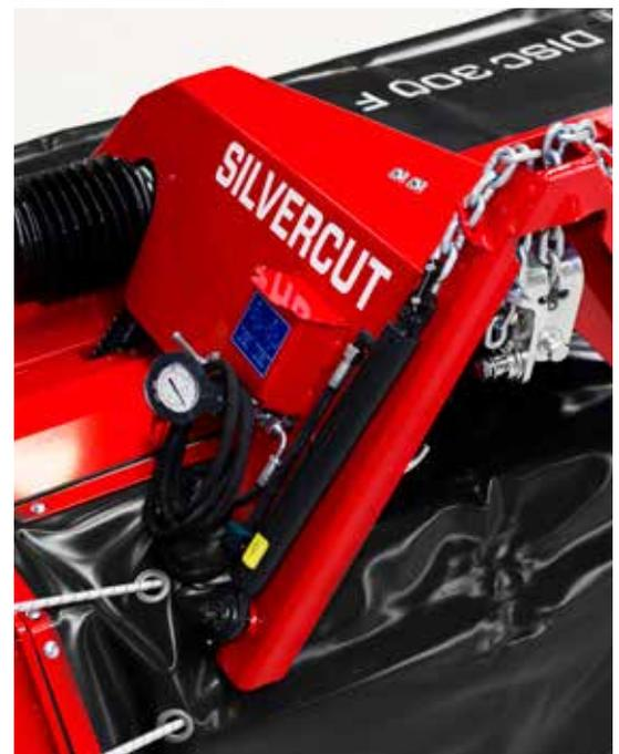
Eine robuste Anschluss mit einer hydropneumatischen Entlastung bietet ausgezeichnete Reaktion auf bewegtem Gelände.
